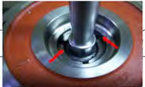
Рис. 4.7. Контроль посадкового місця сальника в корпусі
