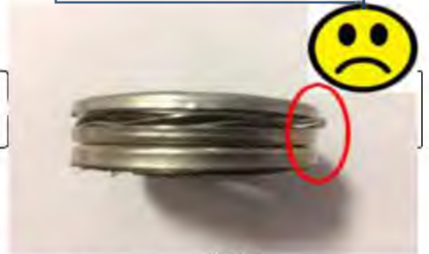
Рис. 4.18. Встановлення сальника з використанням наставки
