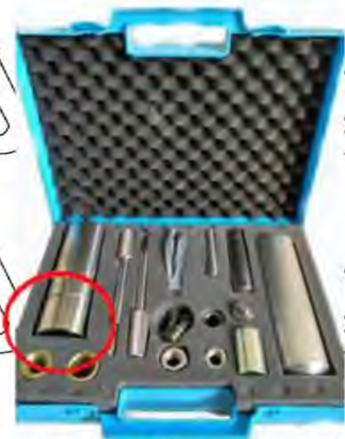
Рис. 4.14. Встановлення відповідного конусу із набору інструментів
