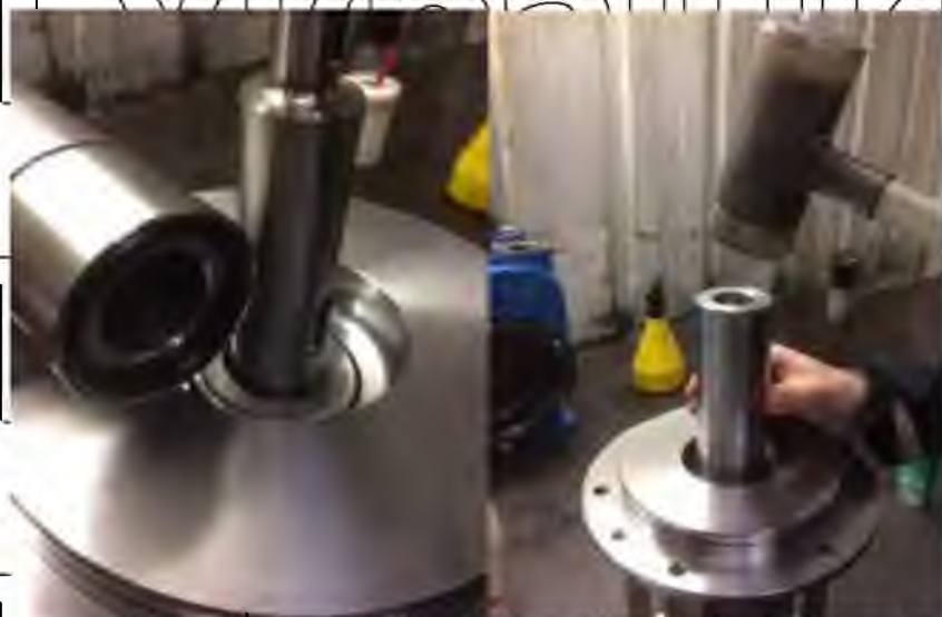
Рис. 4.12. Встановлення кільця до кінця посадкового місця
