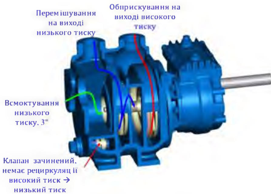
Рис. 1.20. Схема створення тиску насоса Омега
