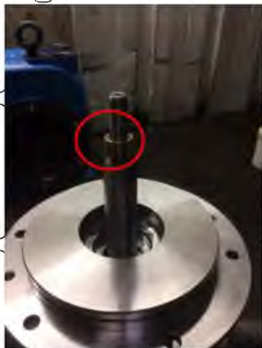
Рис. 4.14. Встановлення відповідного конусу із набору інструментів
