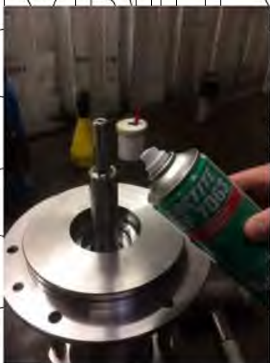
Рис. 4.13. Очистка кільця, за допомогою Loctite SF7063
