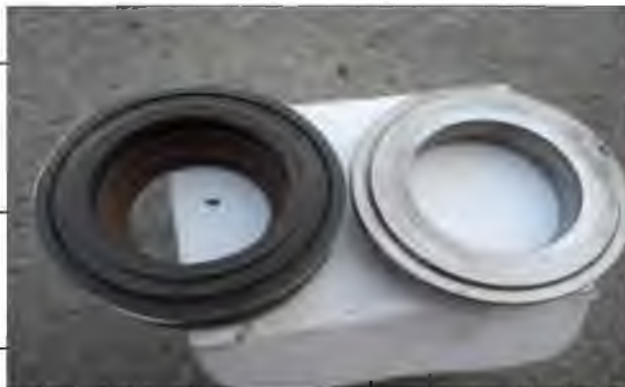
Рис. 4.2. Пошкодження фібри: А - пошкодження торцевої поверхні абразивом; Б - руйнування пружини
