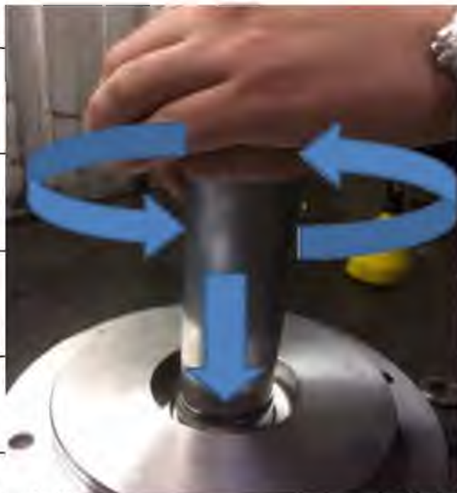
Рис. 4.18. Встановлення сальника з використанням наставки
