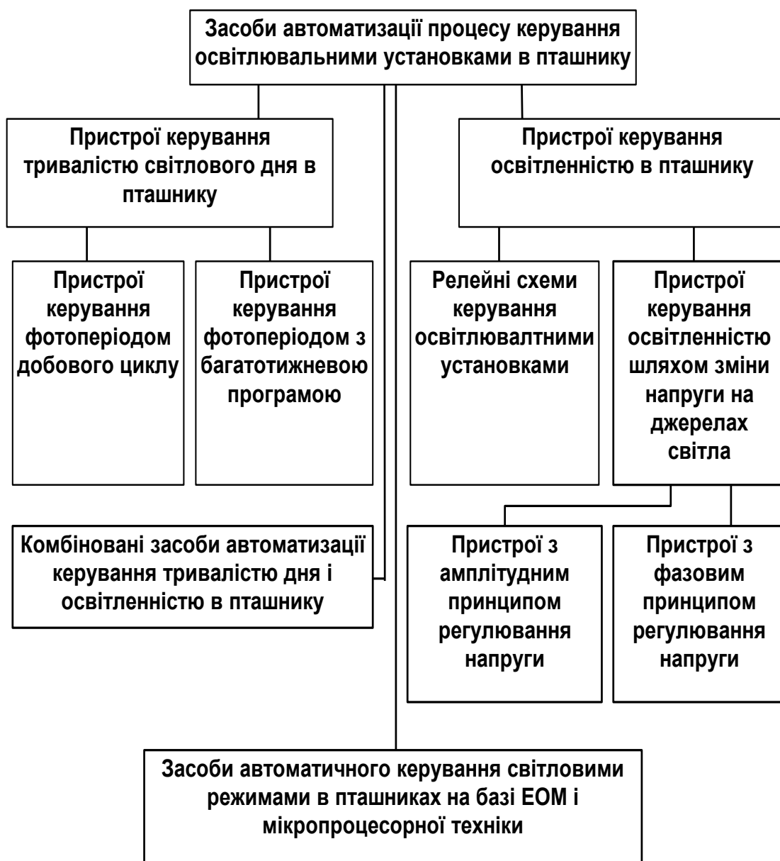
Рис. 1.3. Класифікація автоматизованих систем регулювання рівня освітленості й тривалості світлового дня.
