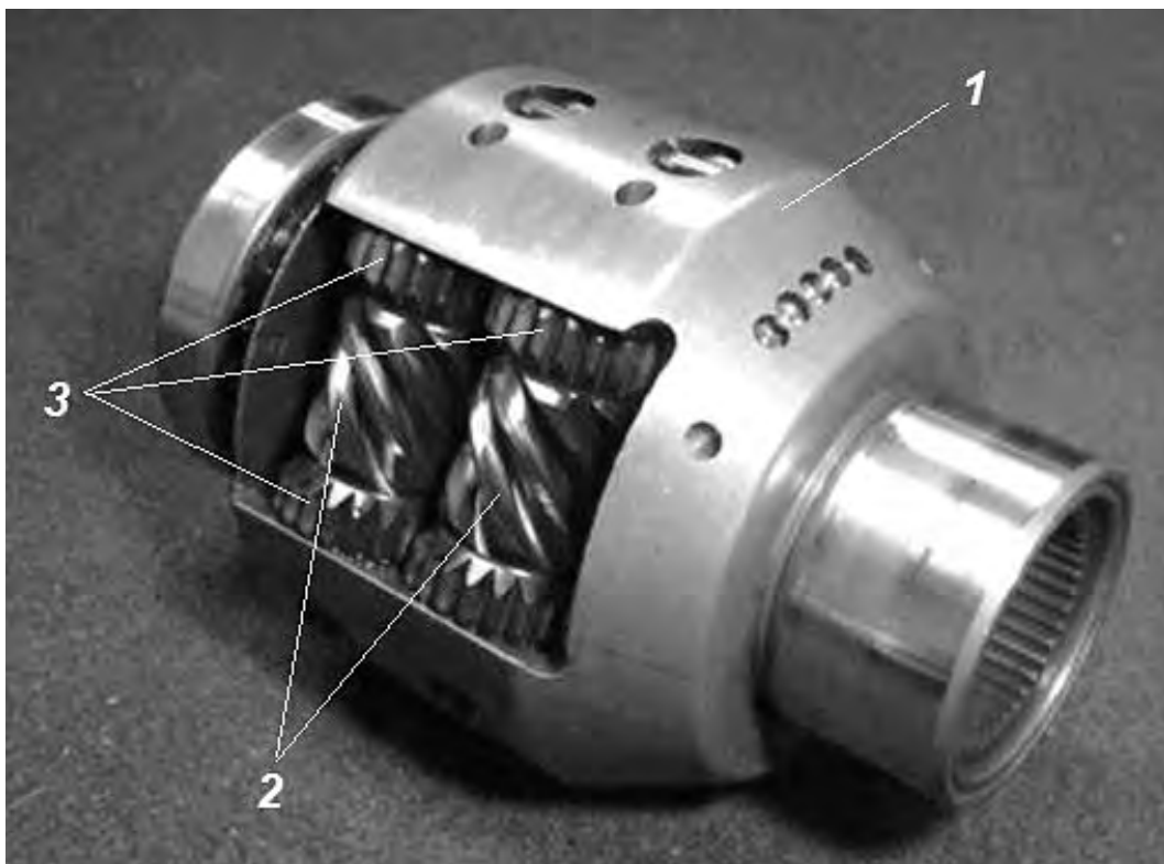
Рис. 5.39. Загальний вигляд диференціалу Torsen [93]:
