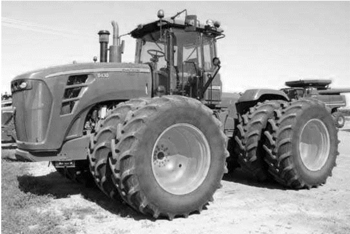
Рис. 2.10. Трактор типу John Deere 9430 з шарнірною рамою
