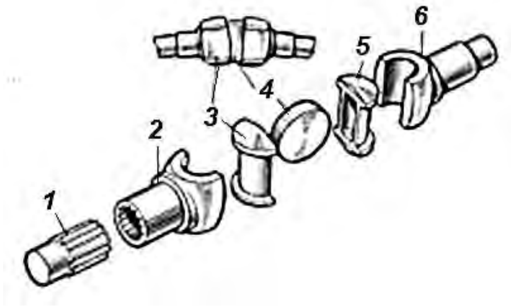
Рис. 4.70. Кулачковий карданний шарнір [27]:
