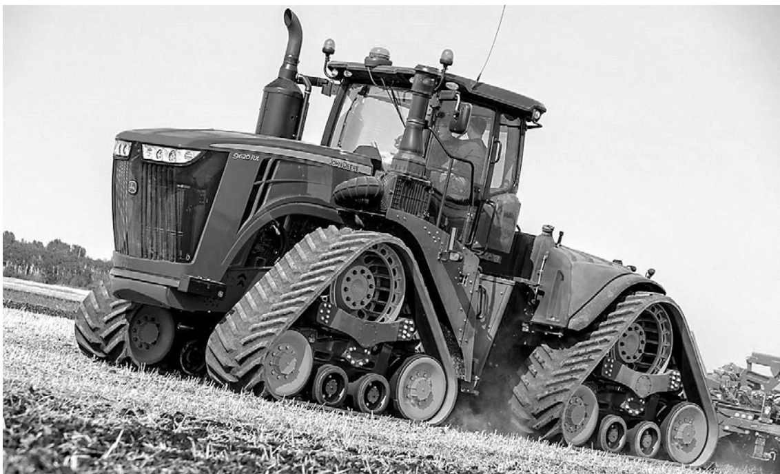
Рис. 2.11. Трактор John Deere серії 9RX з чотиригусеничним рушієм
