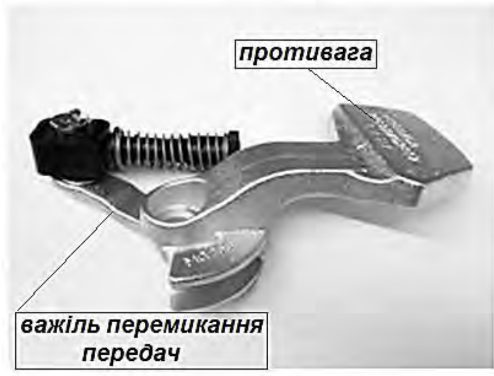
Рис. 4.21. Важіль механізму перемикання передач з противагою автомобіля типу Volkswagen Passat B6
