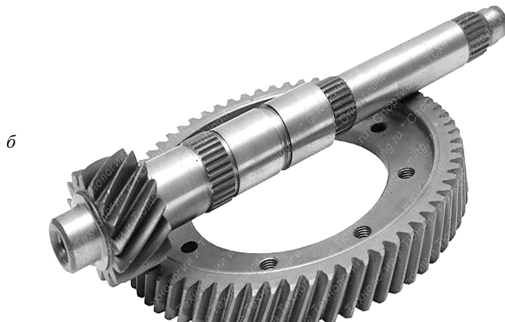
Рис. 5.26. Циліндрична головна передача:
