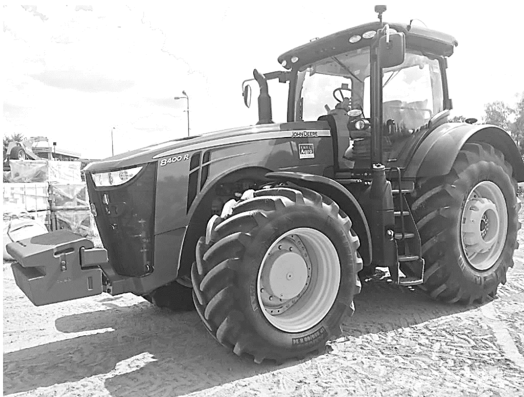
Рис. 2.13. Колісний трактор класичного компонування типу John Deere -8400
