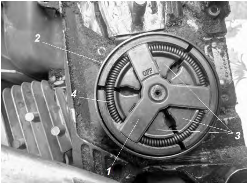
Рис. 3.2. Зчеплення з динамічним замиканням бензопили:
