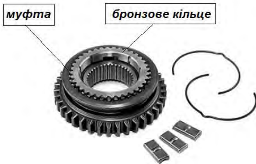
Рис. 4.14. Синхронізатор з проміжним конічним окремим бронзовим кільцем
