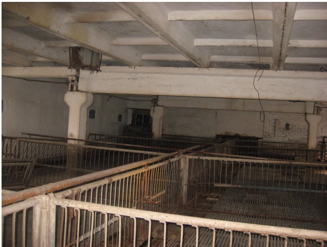
Рис.3. Станки для утримання глибокопоросних свиноматок Годівля нормована з корит. Роздавання корму вручну за допомогою вагонетки та відер. Напування за допомогою соскових автонапувалок ПБС-1.
