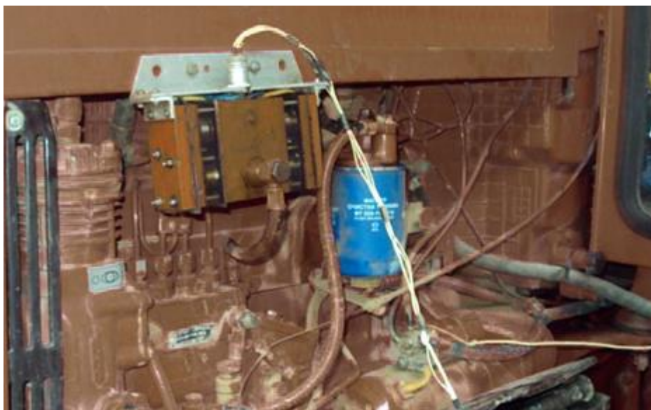
Рис. 4.7- Витратомір палива, встановлений у системі живлення двигуна трактора
