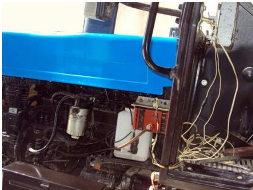
Рис. 4.10 - Монтаж витратоміра палива
