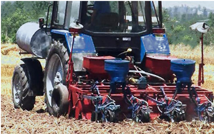
Рис. 5.4 - Комбінована ґрунтообробна посівна машина КГПМ-2,4 в агрегаті з трактором кл. 1.4
