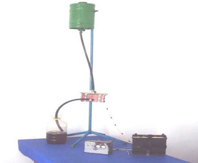
Рис. 4.8 - Тарування витратоміра палива марки
