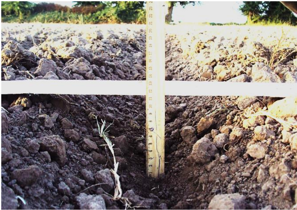
Рис. 4.12 - Вимірювання глибини поливної борозни
