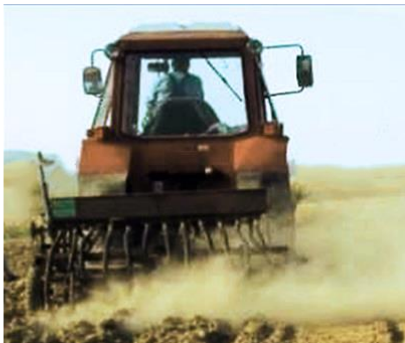
Рис. 4.1. Ґрунтообробно-посівний агрегат (КГПМ-1,8)
