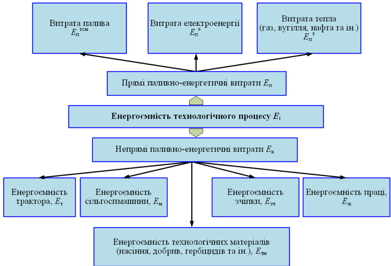
Рис. 2.11 – Структурна схема енергоємності технологічних процесів
