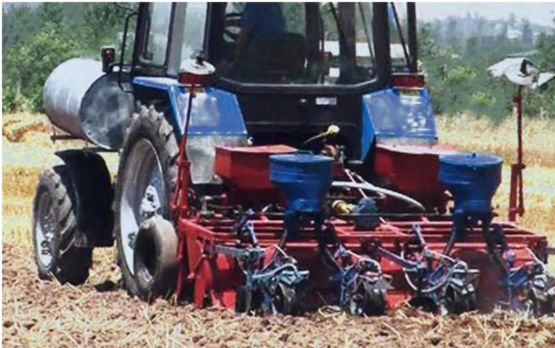
Рис. 4.3. Ґрунтообробно-посівний агрегат (КППМ-2,4)
