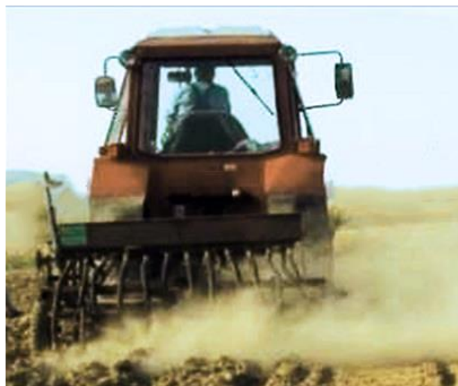
Рис. 5.3 - Комбінований ґрунтообробно-посівний агрегат ЮМЗ-8244+КГПМ-1,8 у процесі експлуатації
