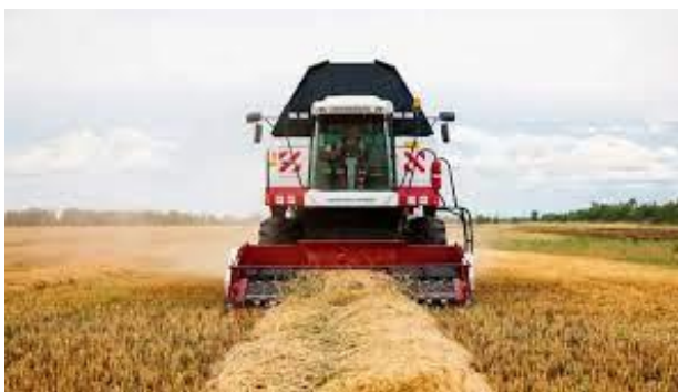
Рис. 4.2. зернозбиральний комбайн «TORUM 440», оснащений платформою-підбирачем, на підборі валка хлібної маси
