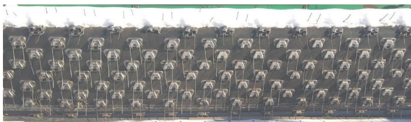
Рис. 1.6. Відсутні та зламані пружинні пальці на транспортері
