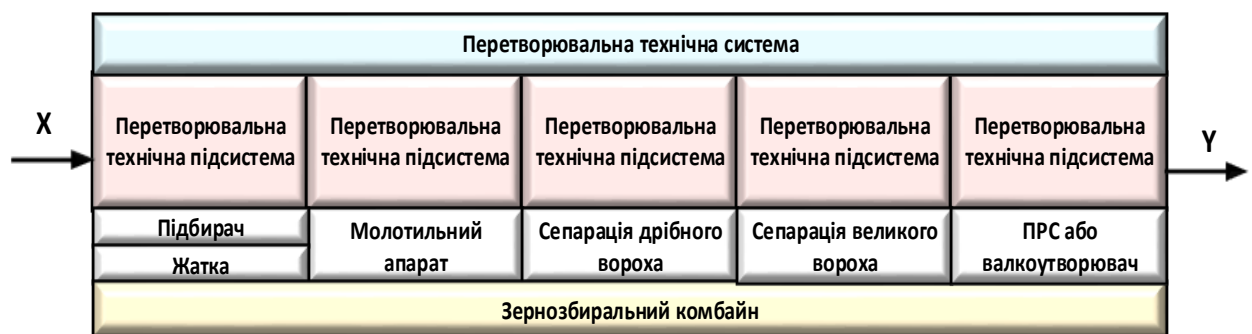
Рис. 2.2. Зернозбиральний комбайн як перетворююча технічна система
