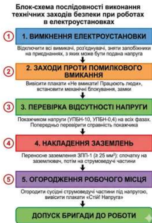
Рис. 4.6. Блок-схема послідовності виконання технічних заходів безпеки при роботах в електроустановках (НПАОП 40.1-1.21-98)
