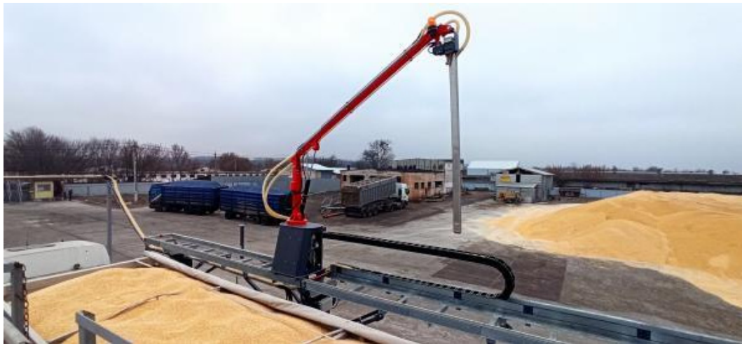
Рис. 3.2. Щуп для відбору проб зерна з автомобіля [89]
