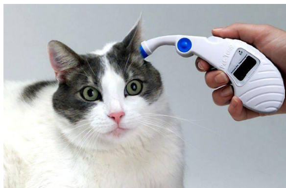
Рис. 1.41. Термометр вушний для дрібних тварин [62]
