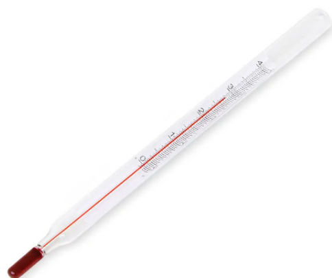
Рис. 1.26. Термометр для інкубатора [47]
