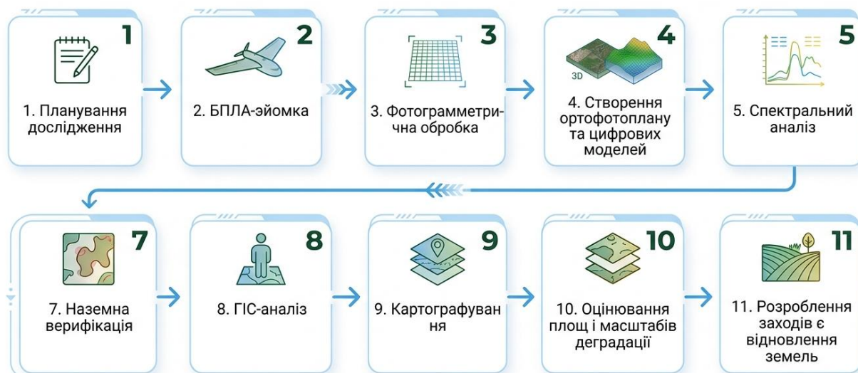
Рисунок 1. Технологічна схема моніторингу сільськогосподарських земель
