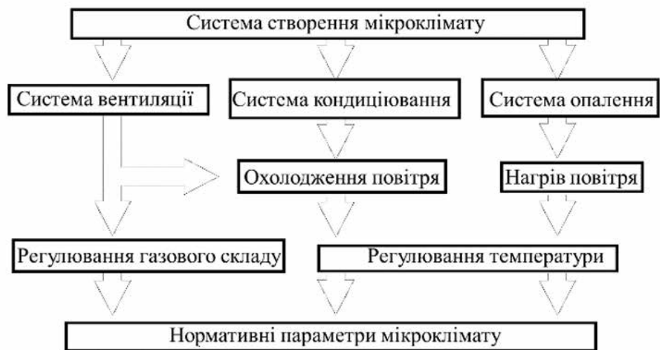
Рис. 1.1. Схема функціонування системи створення мікроклімату
