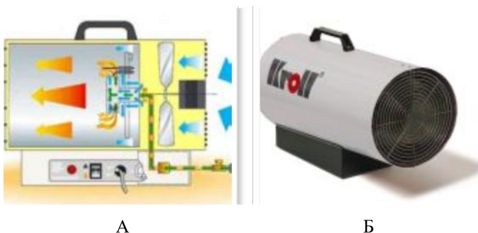
Рис. 2.2. А – схема роботи теплової гармати Kroll P-43; Б – зовнішній вигляд теплової гармати Kroll P-43
