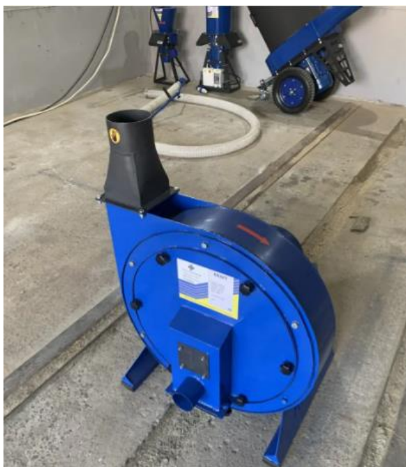
Рис. 3.2. Молотковий подрібнювач Kraft, що використовуватиметься для приготування кормової суміші
