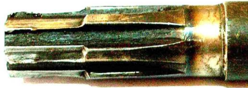
Мал. 1.1 Зовнішній вигляд валу схильного підвищеному зносу
