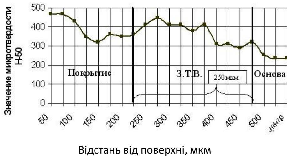
Мал. 3.5 Розподіл мікротвердості по бічній поверхні шліца після нанесеного покриття, мкм
