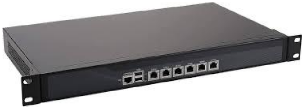
Рис. 2.4 – Апаратний Firewall-шлюз, який реалізує політики ACL і фільтрацію мережевого трафіку.
