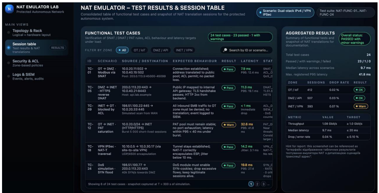
Рис. 4.3 – Табличні результати функціонального тестування NAT-трансляцій та поведінки ACL
