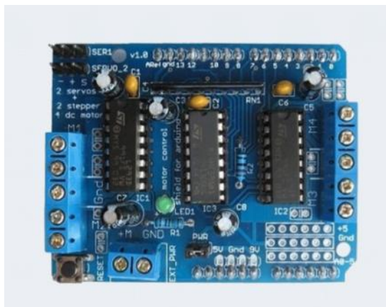
Рис.2.60. Motor shield L293D і плата Arduino
