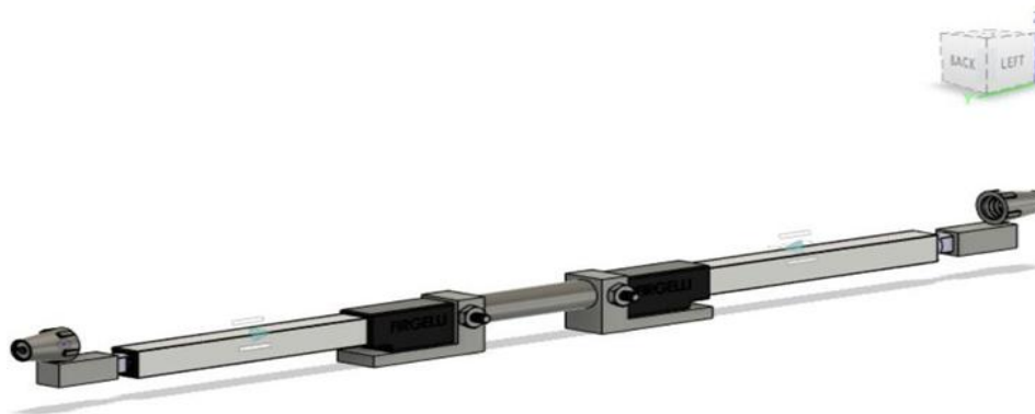
Рис.2.41. Розміщення сопла кінці горизонтальних актуаторів
