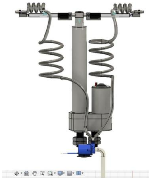
Рис.2.43. З'єднання між насосом і форсунками за допомогою труб
