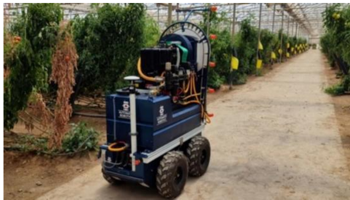
Рис. 1.2. Автономний робот-обприскувач пестицидів
