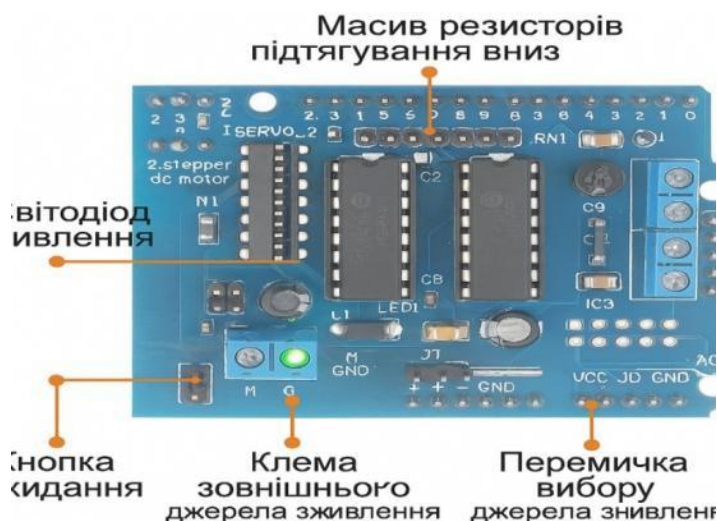
Рис.2.2. Подача живлення на екран електродвигуна
