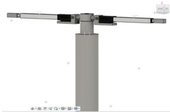
Рис.2.34. Т-подібне з'єднання між приводами без фіксуючого гвинта
