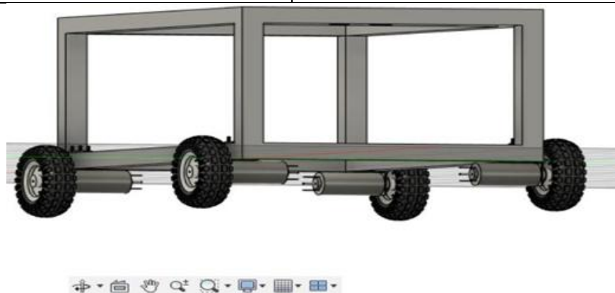
Рис.2.24. Кріплення колеса до осі двигуна
