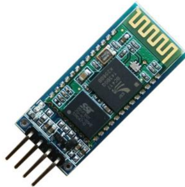
Рис.2.59. Bluetooth-модуль HC-05(Ref. С. 004)
