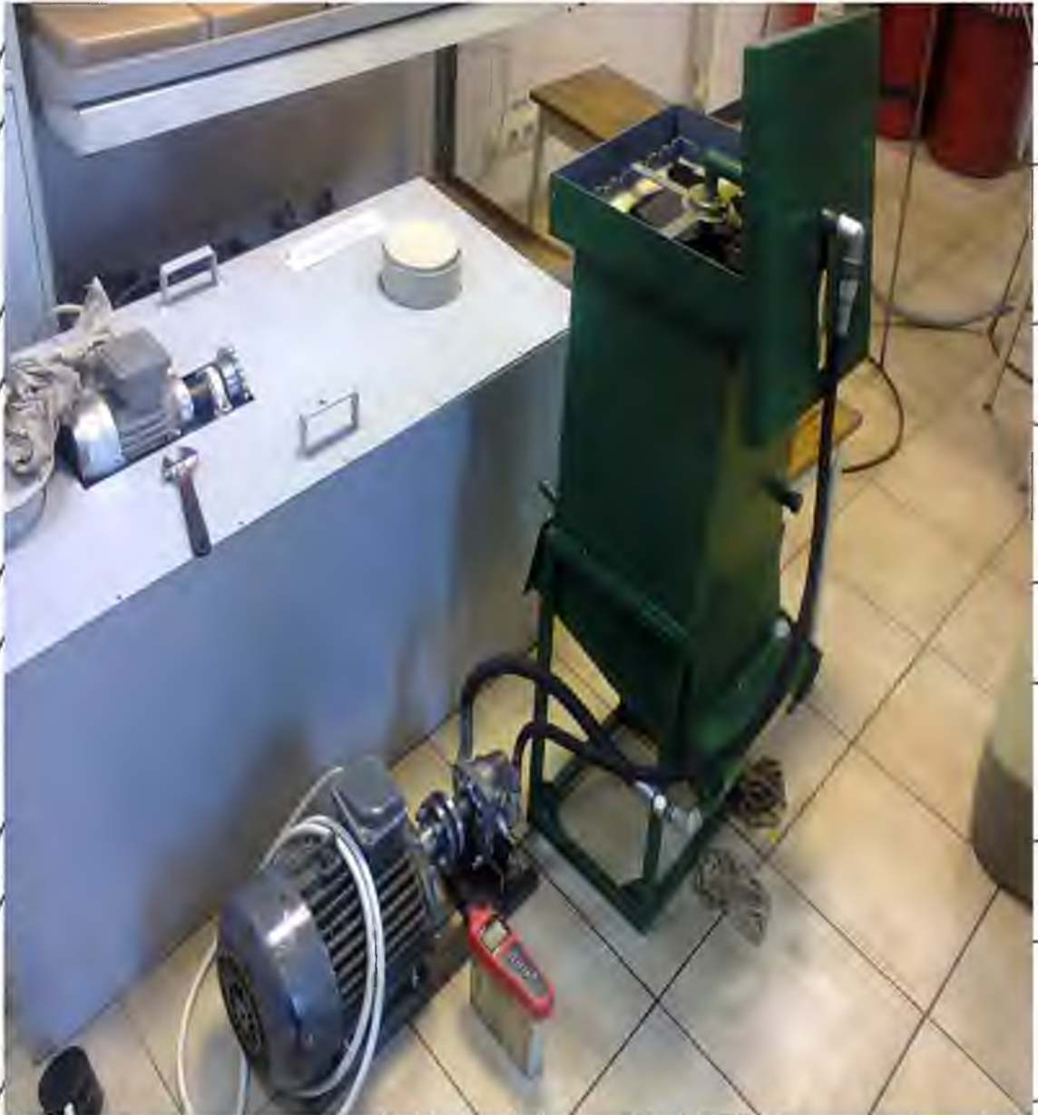
Рис. 2.1 Експериментальна установка для естерифікації ріпакової олії в біодизель
