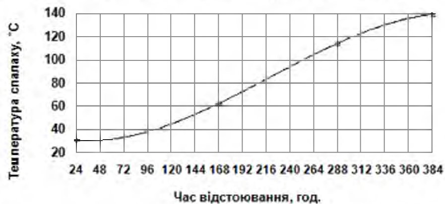
Рис. 3.4. Вплив часу відстоювання з доступом повітря на температуру спалаху біодизеля
