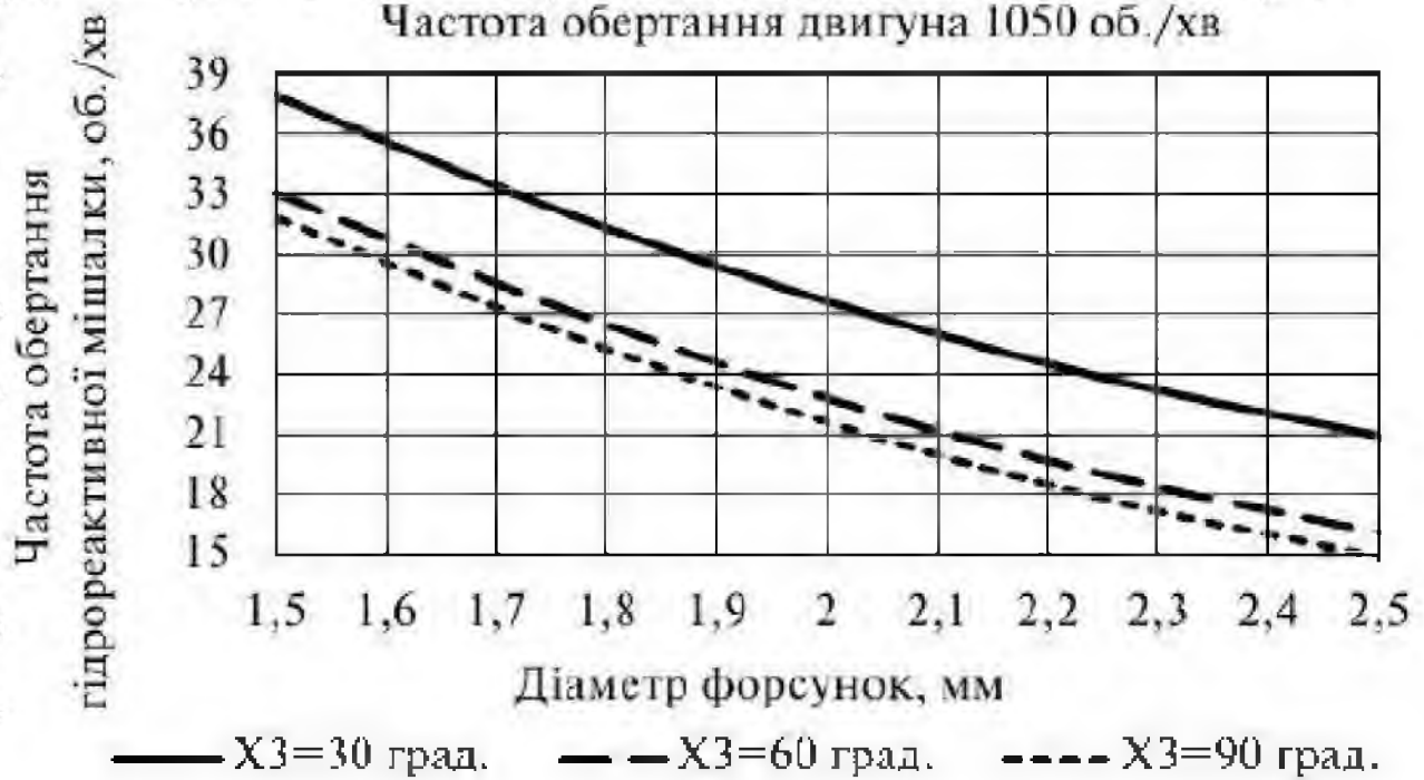
Рис. 3.12. Залежність частоти обертання гідрореактивної мішалки від діаметра форсунок
