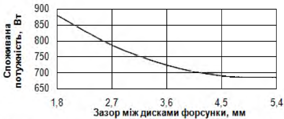
Рис. 3.6. Залежність споживаної потужності дискового змішувача від зазору між дисками форсунки
