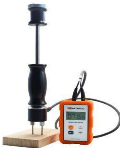
Рис. 4.1. Процес контролю вологості деревини перед процесом зрощування бруса
