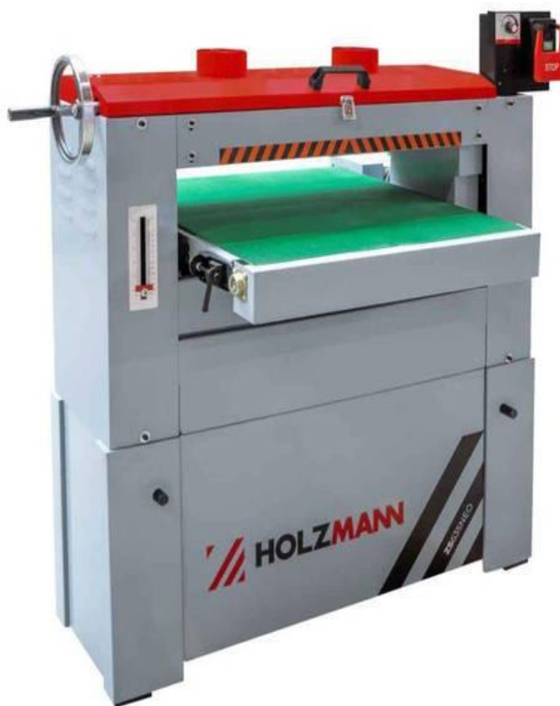
Рис. 4.2. Обладнання для калібрування та шліфування зрощеного бруса
