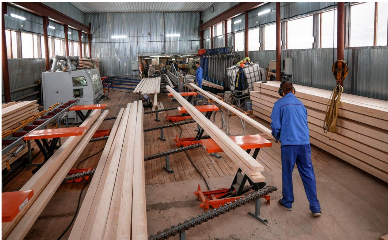
Рис. 4.3. Автоматизована лінія зрощування заготовок на мікрошип
