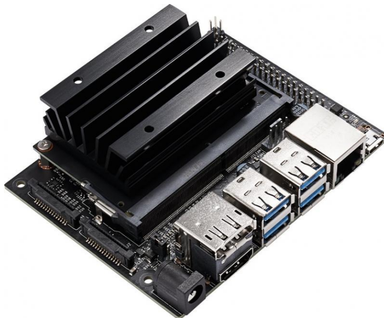
Рис. 2.4 – Компаньйон-комп'ютер NVIDIA Jetson Nano для інференсу моделей розпізнавання образів
