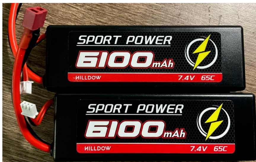
Рис. 2.2 – Літій-полімерні батареї живлення стенду Hilldow Sport Power 6100 mAh (2×7.4 В)
