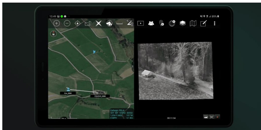
Рис. 1.11 – Інтерфейс Auterion Skynode з відображенням потоків RGB і теплового відео під час польоту
