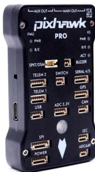
Рис. 2.3 – Контролер польоту Pixhawk PRO (інтерфейси I/O, CAN, UART, SPI)
