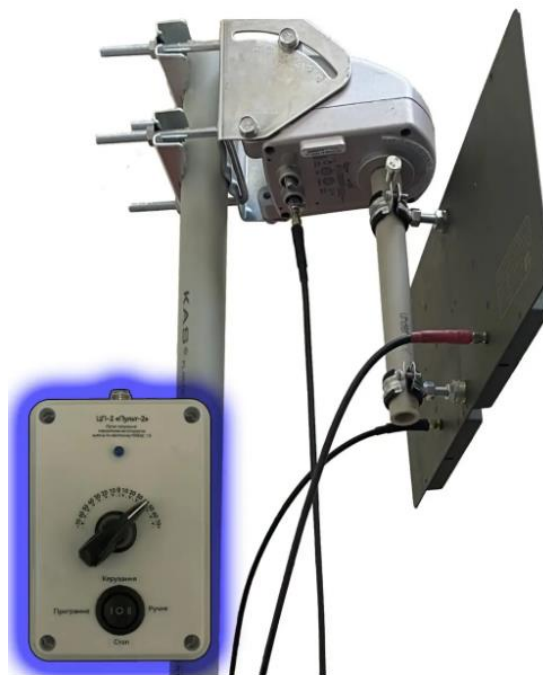
Рисунок 2.5 – зовнішній вид однієї з моделей поворотної антени РЕБ в комплекті з механізмом плавного керування
