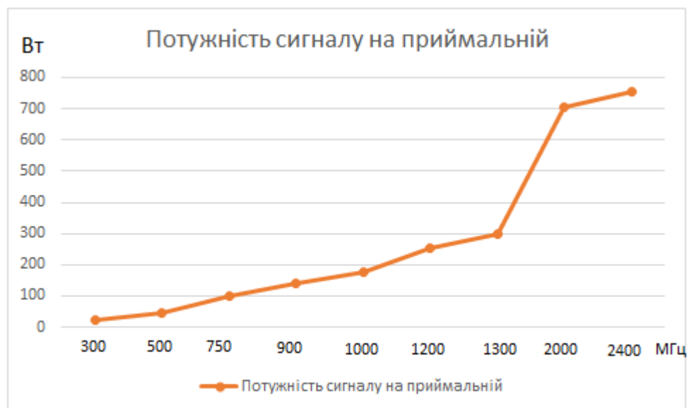
Рисунок 2.11 – графічні залежності між частотою протидії та номінальною потужністю пристрою РЕБ
