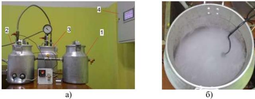
Рисунок 3.4 – Експериментальна установка дослідження бактеріологічного знезараження (обсіменіння): а) загальний вигляд; б) робочий процес
