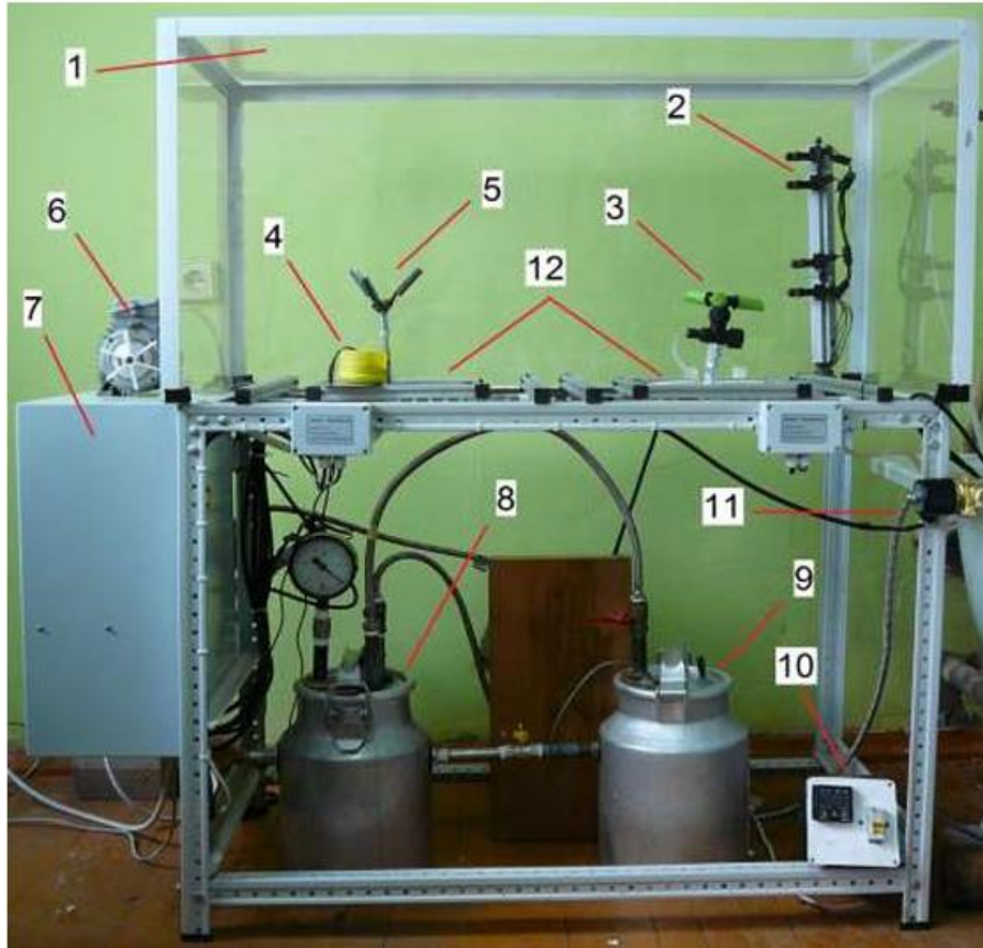
Рисунок 3.7 – Напівпромисловий зразок комплексної мийної установки: 1 – захисний екран; 2 – форсунки для зовнішнього миття ємностей; 3 – багатопозиційна мийна головка; 4 – ультразвуковий туманогенератор; 5 – пристрій механічного очищення; 6 – електродвигун; 7 – шафа автоматики; 8 – ємність підготовки миючого (дезінфікуючого) розчину; 9 – ємність озонатора; 10 – терморегулятор; 11 – система зливу; 12 – обертові елементи
