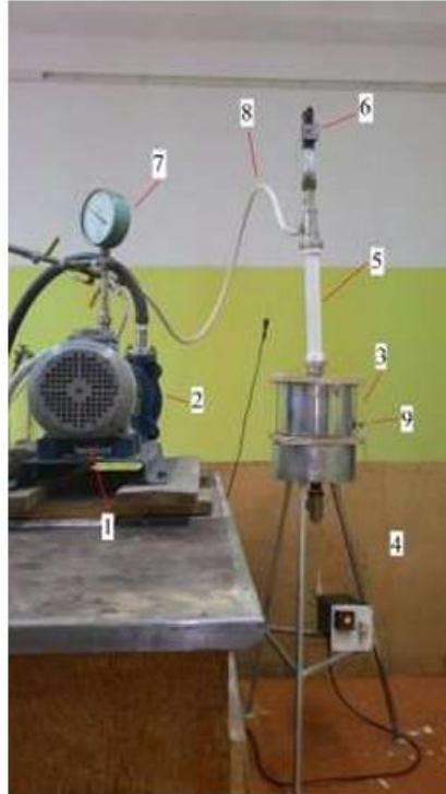
Рисунок 3.3 - Загальний вигляд експериментальної установки: 1 - електродвигун; 2 - ЖВН; 3 - парогенератор; 4 - ПД-регулятор з термопарою; 5 - змінна ємність; 6 - електронний вакуумметр; 7 - аналоговий вакуумметр; 8 - магістральний трубопровід; 9 - ТЕН
