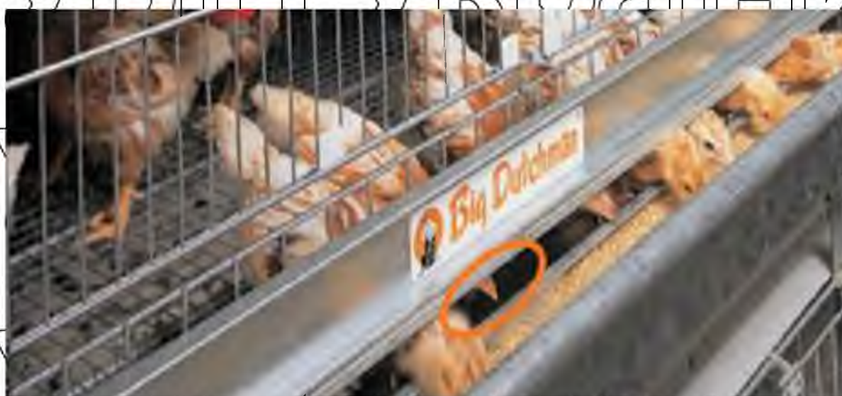
Рис.3.1. Внутрішній лоток для запобігання втрат корму
