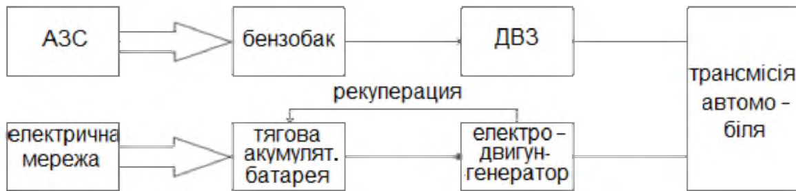
Рис. 2. Функціональна схема гібридного автомобіля з підзарядкою
