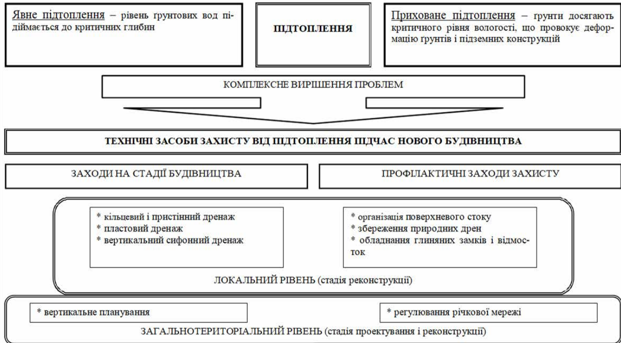
Рис. 1. Схема запобігання і ліквідація підтоплення на різних рівнях
