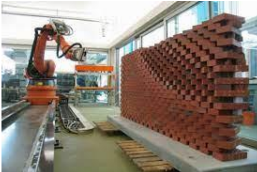
Рис. 2. Використання робота для мурування кам'яної кладки
