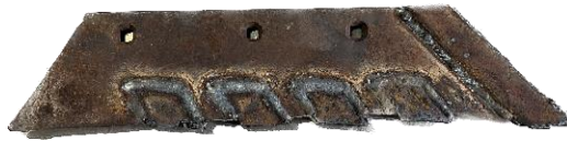
Рисунок 3 – Плужний леміш з постановкою компенсуючих вставок
