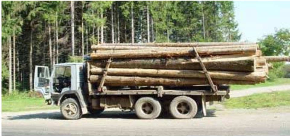
Рис. 1.3. Автомобіль КамАЗ 5320 переобладнаний для перевезення лісоматеріалів
