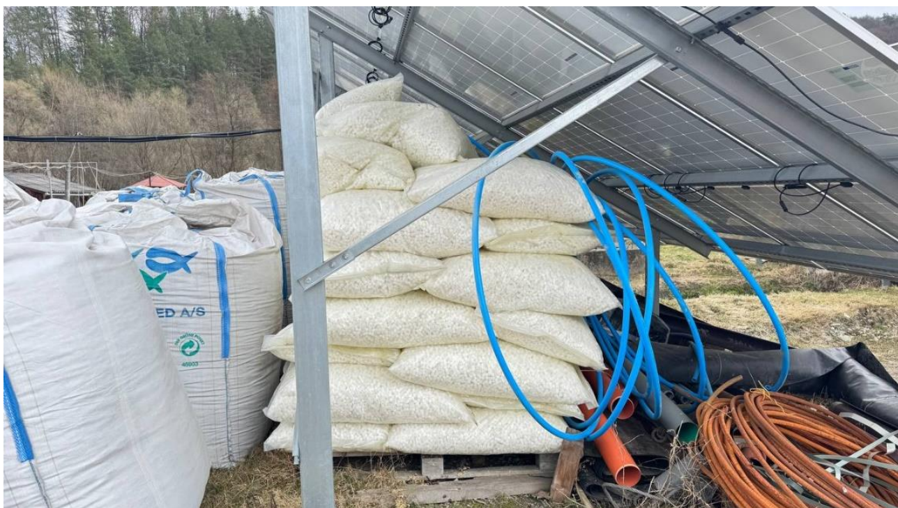
Рис. 3.2.2. Біозавантаження для біофільтра УЗВ господарства «Голуба Нива»
