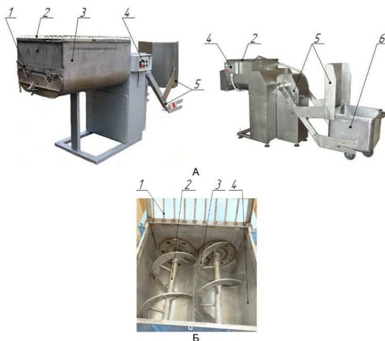
Рис 1.5 Фаршмішалка Л5-ФМ2-У-335: а – загальний вигляд: 1 - ричаг шибєру торцьового вивантаження фаршу; 2 - захисна кришка; 3 - діжа; 4 - пульт управління; 5 - завантажувач; 6 - візок для сировини; б – робоча камера: 1 - захисна кришка; 2, 3 - спіралі; 4 - діжа фаршмішалки
