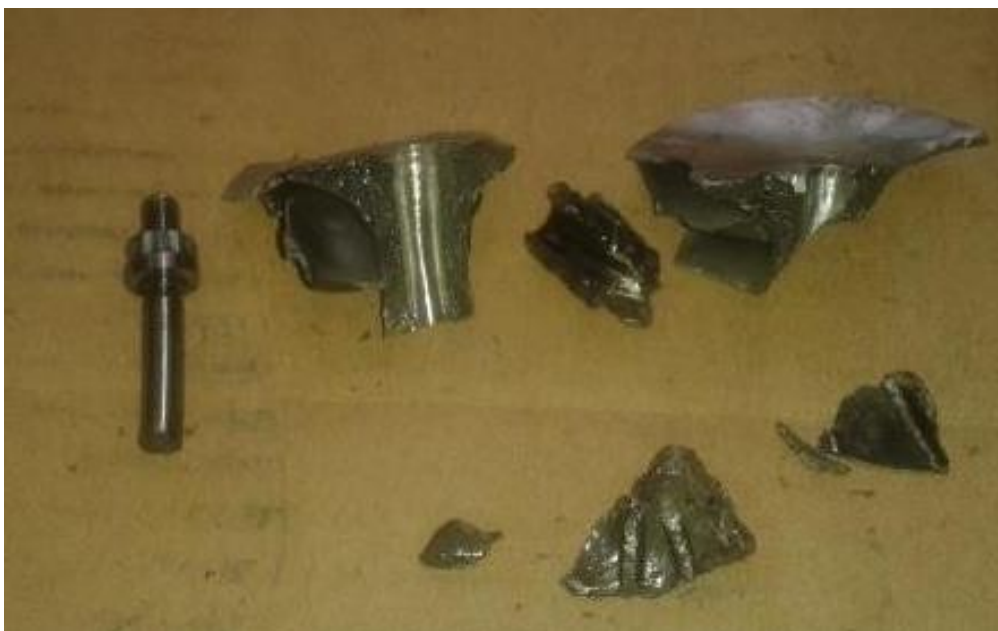
Рис.3.4 – Осколки робочого колеса компресора і кінцевик ротора.
