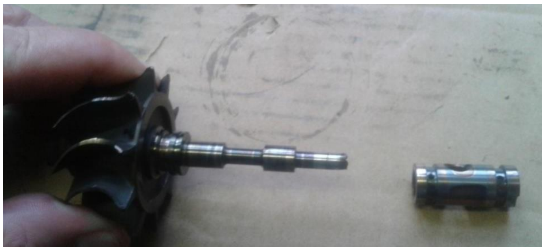
Рис.3.5 – Демонтований фрагмент ротора і моноштулка підшипника.
