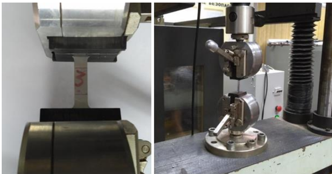
Рис.3.8 – Схема закріплення дослідного зразка в випробувальній машині
