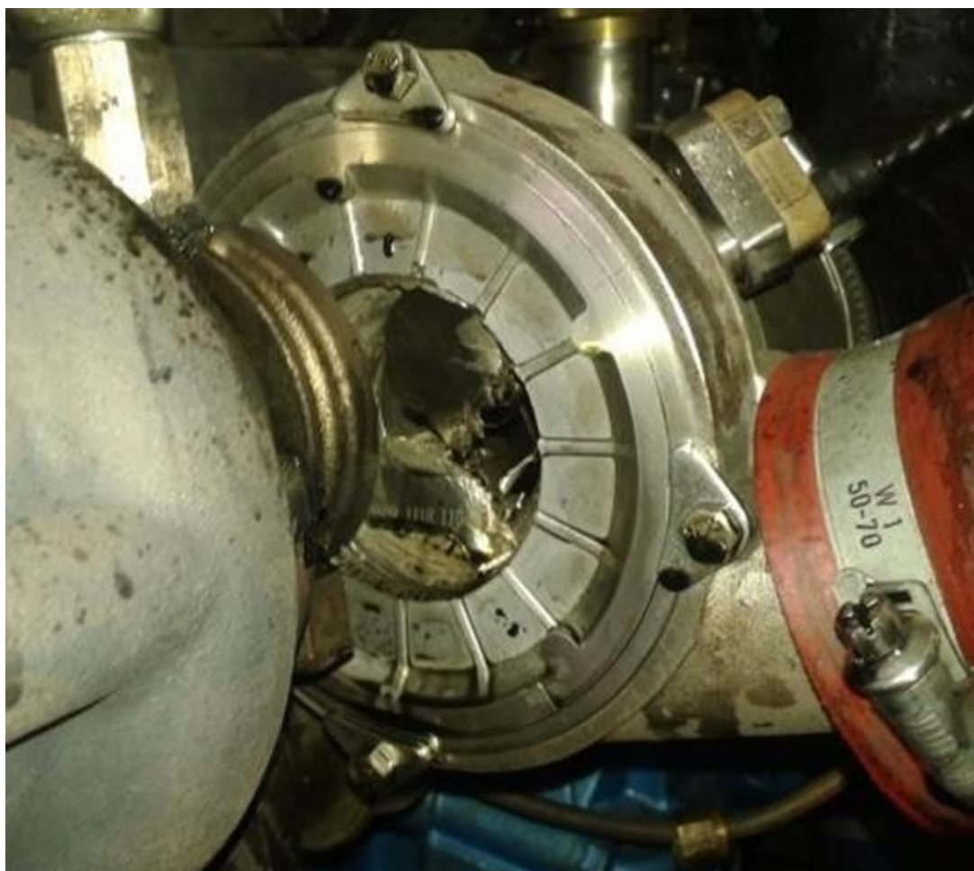
Рис.3.2 – Загальний вигляд місця руйнування ТКР-50
