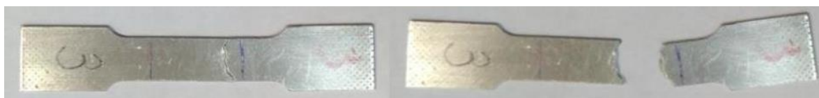
Рис.3.9 – Фотографія опытного образца №3.1 (образец, вырезанный из третьей заготовки РК) до и после разрушения.
