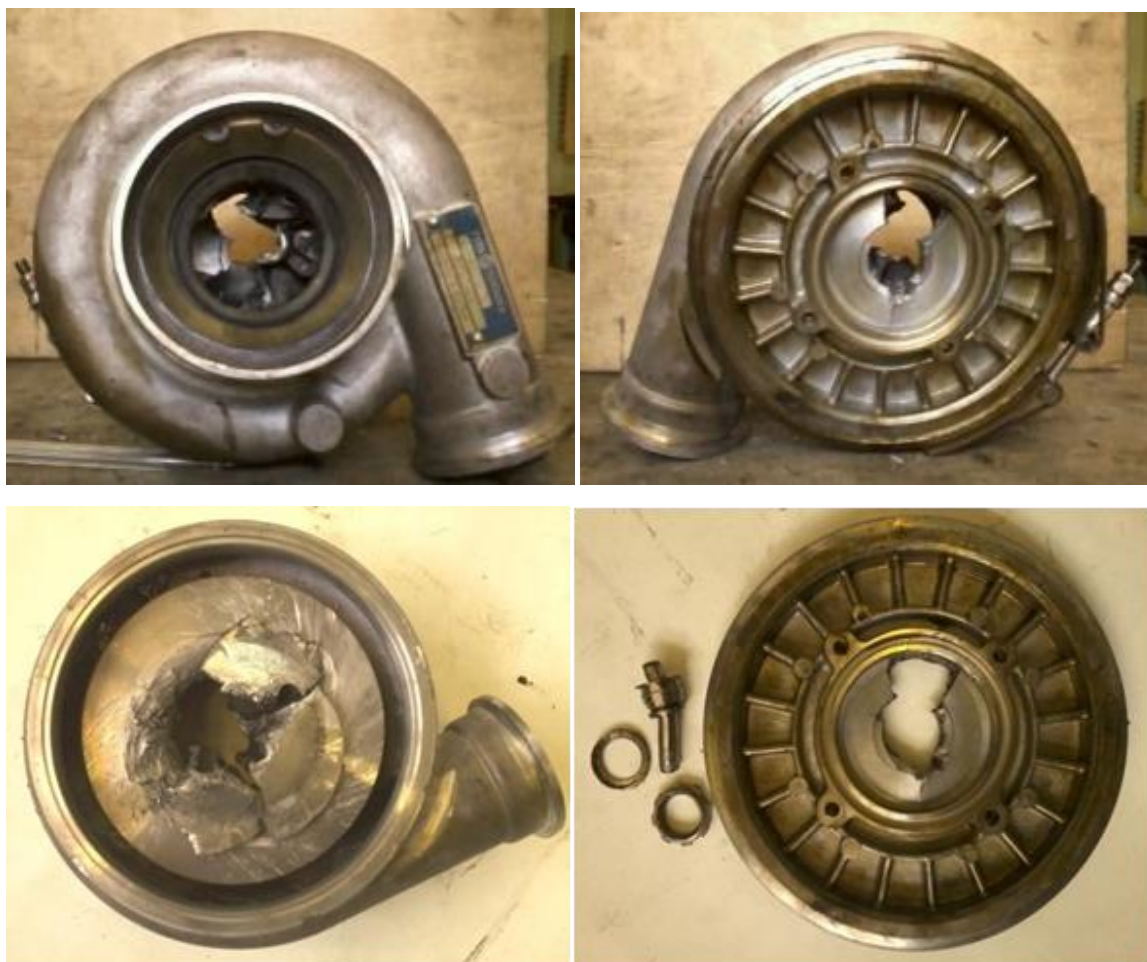
Рис.3.6 – Демонтована компресорна частина ТКР-80 з осколками колеса і кінцевиком ротора.
