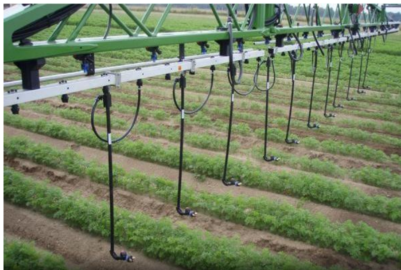
Рис. 5. Система Dropleg від Amazone, Lechler і Syngenta
