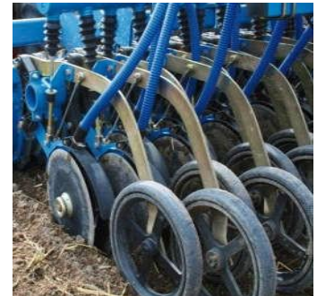
Рис. 1.13. Дискові сошники: а -2S-2600 («Great Plains», США); б - моделі 455, 1590 і BD 11 («John Deere», США); в - Solitair 12/1200 KD-S («Lemken», Німеччина).
