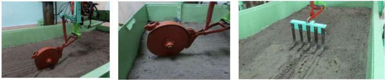
Рис. 3.2. Експериментальні робочі органи: a - серійний сошник; б - вдосконалений сошник, в - касета пластин
