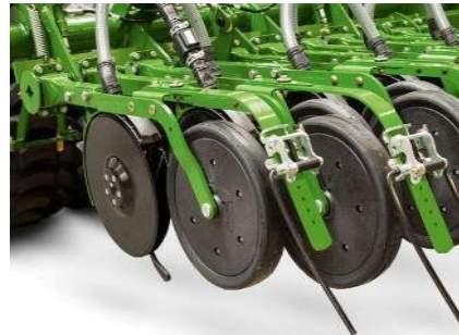
Рис. 1.13. Дискові сошники: а -2S-2600 («Great Plains», США); б - моделі 455, 1590 і BD 11 («John Deere», США); в - Solitair 12/1200 KD-S («Lemken», Німеччина).
