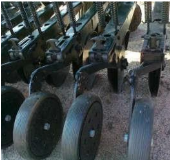
Рис. 1.13. Дискові сошники: а -2S-2600 («Great Plains», США); б - моделі 455, 1590 і BD 11 («John Deere», США); в - Solitair 12/1200 KD-S («Lemken», Німеччина).
