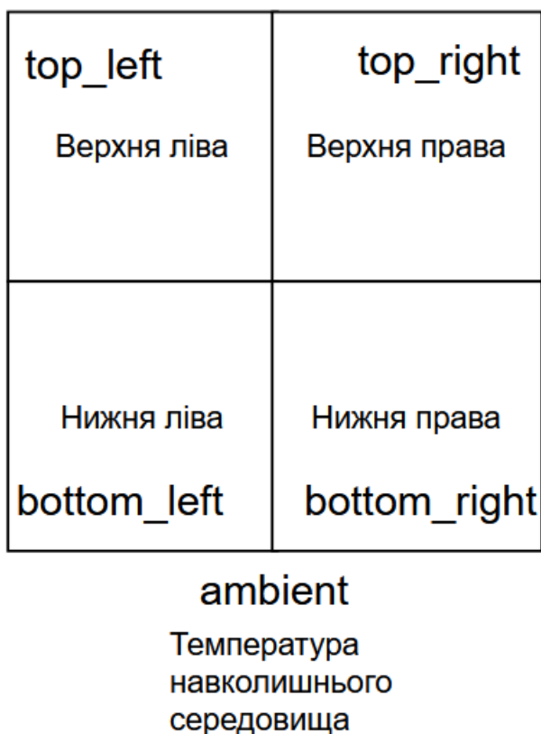
Рисунок 3.3 – Схема розташування контрольних температурних зон сонячної панелі
