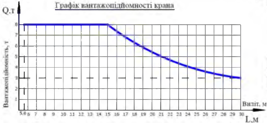
Рис. 5.1. Технічні характеристики баштового крана КБ-573
