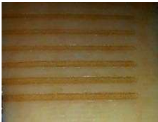
Рис. 3.17. Зовнішній вигляд штрихкоду маркування при швидкості V_2 = 0,04 м/с: а – сир, б – сирний продукт.
