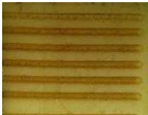
Рис. 3.21 – Зовнішній вигляд маркування при різних частотах проходження імпульсу: а – сир, б – сирний продукт
