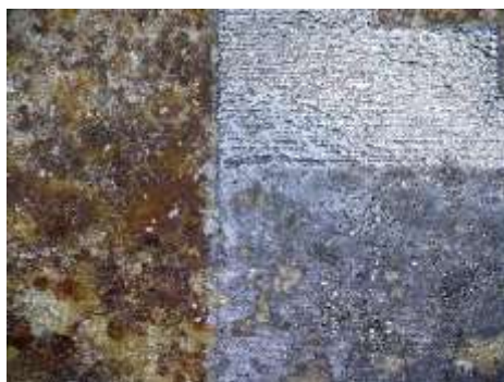
Рис. 4.14. Вид поверхні сталевго зразку після очищення при різних умовах фокусування.
