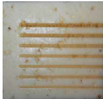
Рис. 3.17. Зовнішній вигляд штрихкоду маркування при швидкості V_2 = 0,04 м/с: а – сир, б – сирний продукт.
