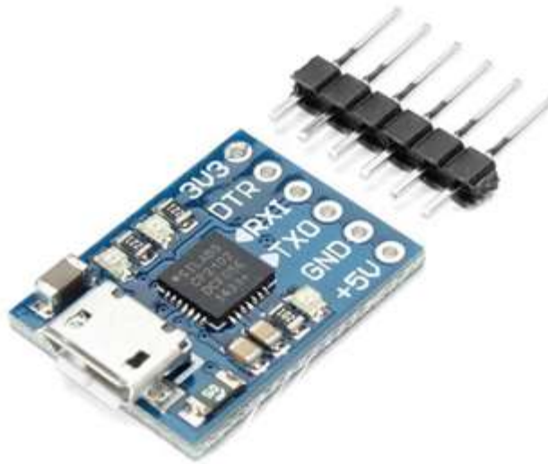
Рис. 3.8. Перетворювач USB to UART на базі CP2102 Arduino
