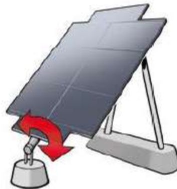
Рис. 1.3. Сонячний трекер із вертикальною віссю обертання
