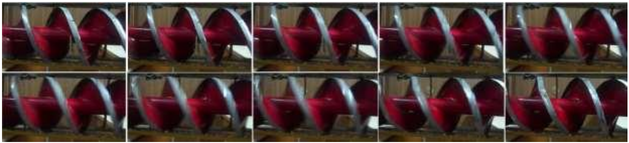
Рис. 3. Різання одного стебла ріжучим апаратом
