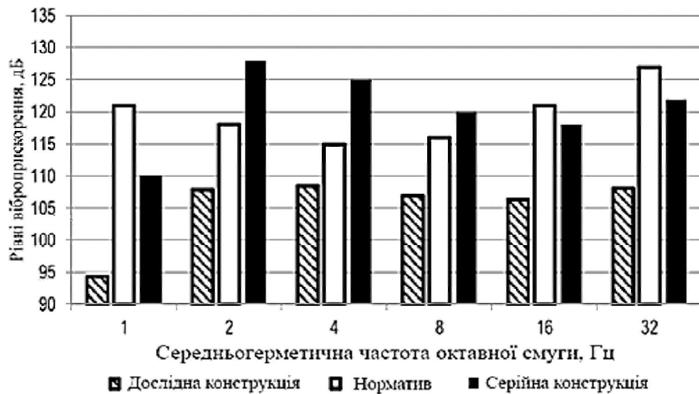
Рис. 1.11 – Порівняльні випробування вібраційної навантаженості робочого місця оператора ТТА у складі (МТЗ-1221.2 + 2ПТС-4,5) на ґрунтовій дорозі на швидкості 30 км/год
