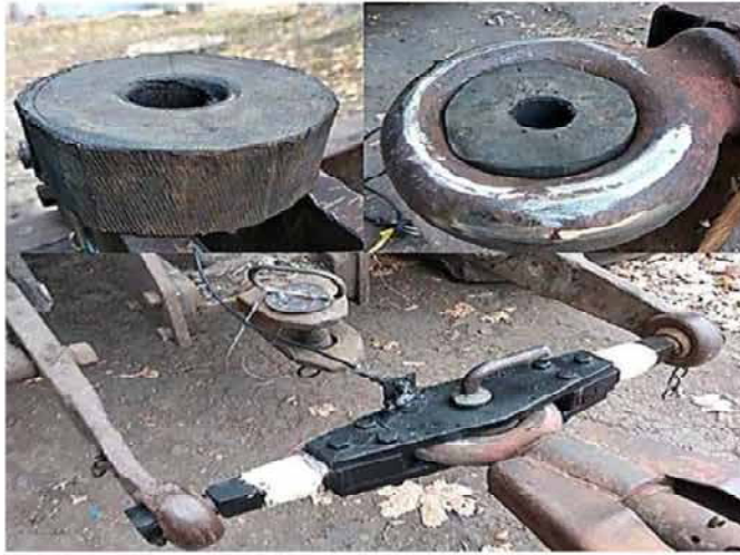
Рис. 3.14 – Демпфер для зниження ударних навантажень
