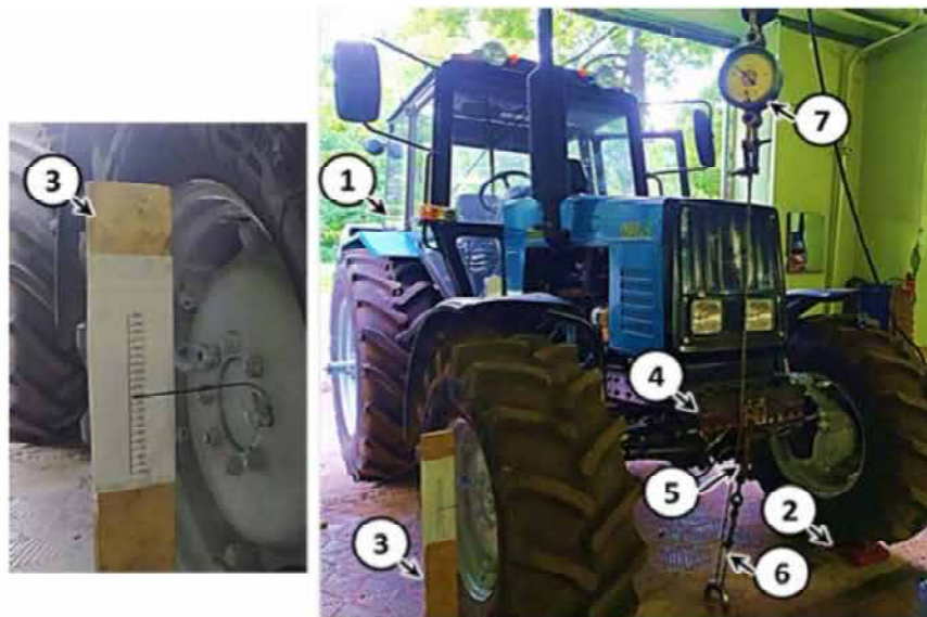
Рис. 3.8 – Вимірювання жорсткості передніх шин трактора: 1 - трактор; 2 - тензометричні ваги; 3 - вимірювальна дошка; 4 - передній звис трактора; 5 - тяга; 6 - трос з'єднувальний; 7 - динамометр розтягування
