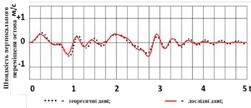
Рис. 4.7 – Швидкість вертикальних переміщень остова під час переїзду одиначної нерівності
