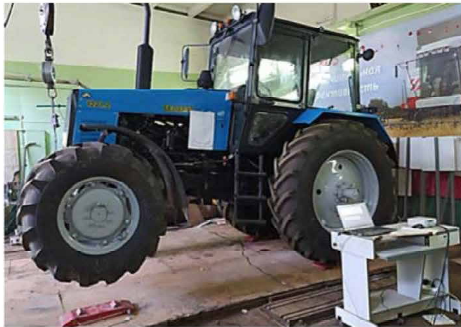
Рис. 3.10 – Визначення вертикальної координати центру ваги трактора Кут змінювався дискретно з кроком 2,5^\circ до 5^\circ .
