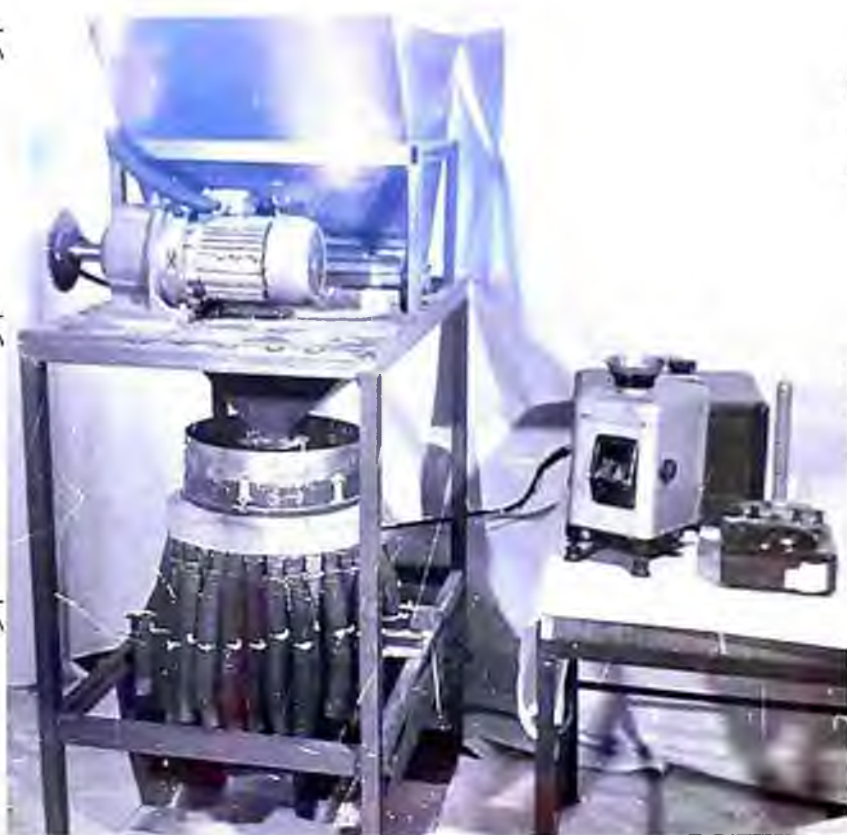
Рис. 3.3 Загальний вигляд лабораторної установки для дослідження пропускної здатності розподільника і якості розподілу добрив по відвідних патрубках
