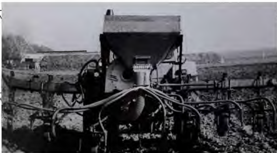
Рис.3.13 Загальний вигляд експериментального зразка машини з багатоканальною висівною системою.
