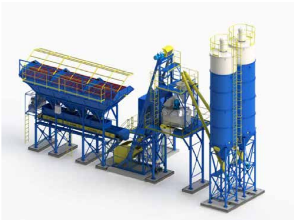
Рис. 2.8 Схема розміщення бетонозмішувального обладнання.
