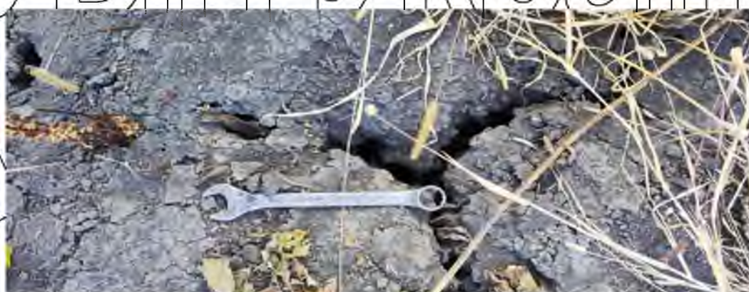
Рисунок 2.14. – Тріщини у ґрунті та гайковий ключ на 24.
