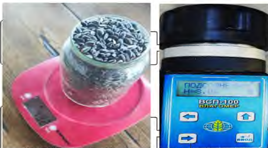
Рисунок 2.16. – Визначення об'ємної ваги та вологи зерна.
