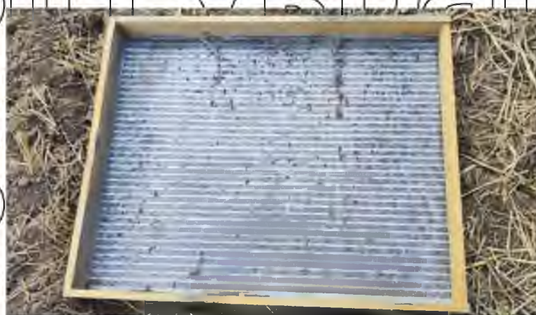
Рисунок 2.17. – Лоток для підрахунку втрат після зернозбирального комбайна 76x63.
