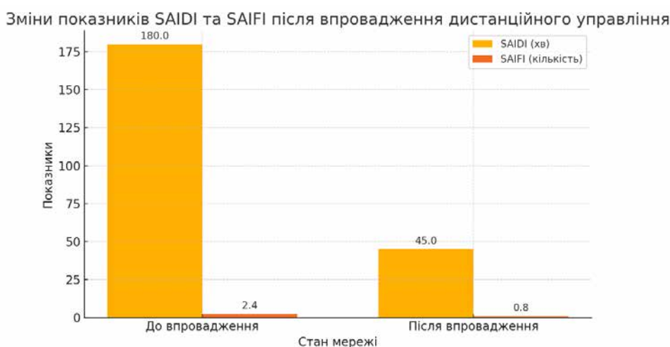
Рис. 2.2 Зміни показників SAIDI та SAIFI після впровадження дистанційного управління
