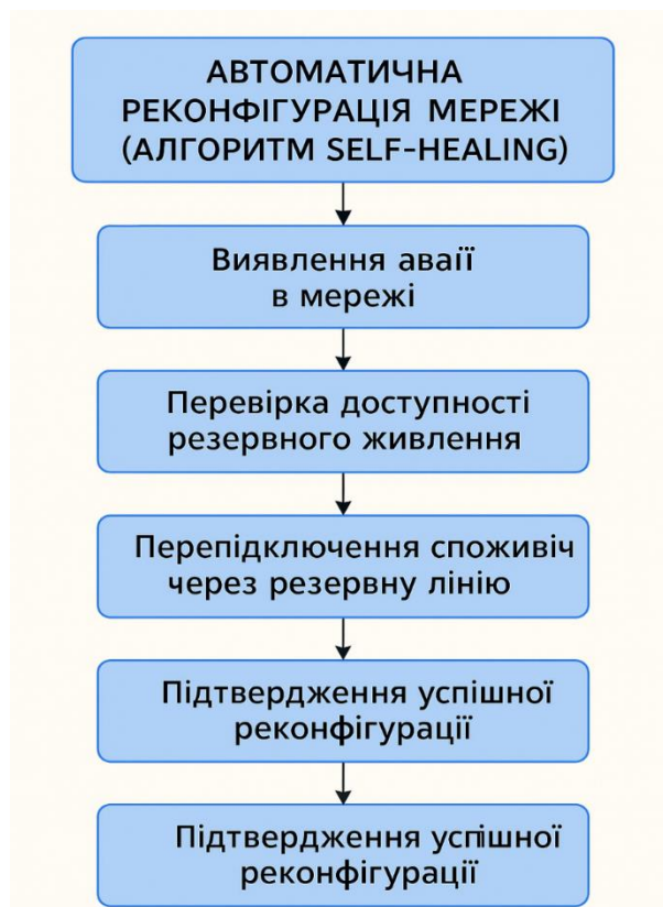
Рис. 3.2 Автоматична реконфігурація мережі
