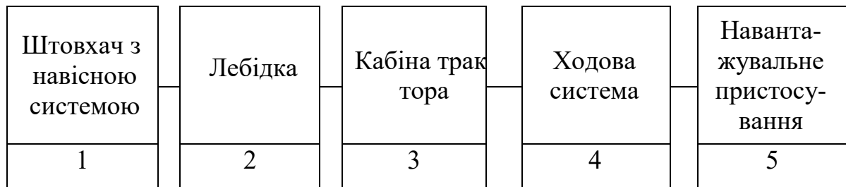
Рис. 2.2. Структурна схема надійності системи (трелювального трактора ТДТ-55А).
