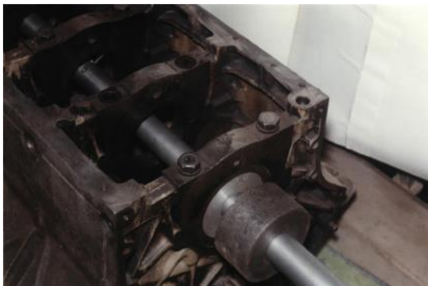
Рис. 25 Розточний вал на блоці циліндрів в зборі з маховиком
