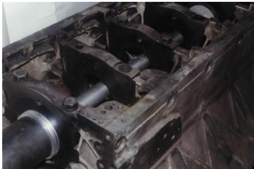
Рис. 26 Розточний вал на блоці циліндрів в зборі з подаючим редуктором і різцем.
