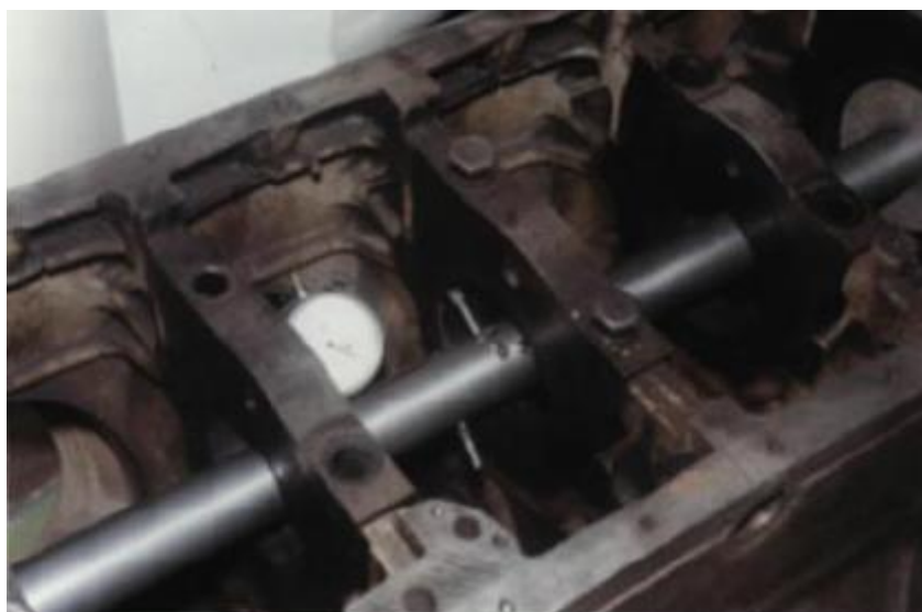
Рис. 27 – Розточний вал в зборі з елементами вимірювального пристрою (Індикатором годинникового типу і вимірювальним штоком) і різцем а - поза блоком циліндрів; б - на блоці циліндрів
