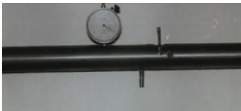
Рис. 26 Розточний вал на блоці циліндрів в зборі з подаючим редуктором і різцем.
