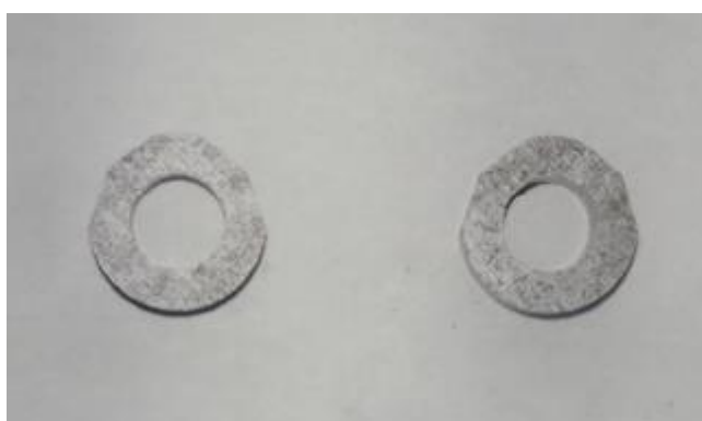
Рис. 24. Елементи, що базують розточний вал в ЛКП
