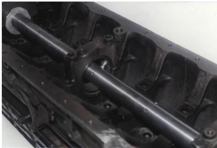
Рис. 29 Розточена постіль корінного підшипника КШМ
