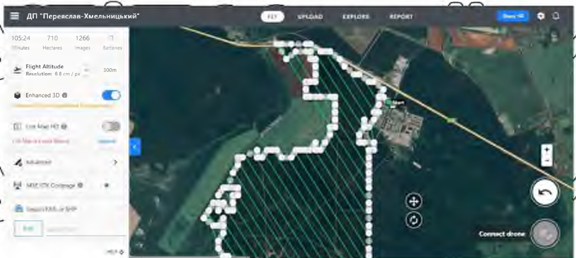
Рис. 10. Контур виконання ортофотознімання в ПО DroneDeploy (скріншот власного екрану).
