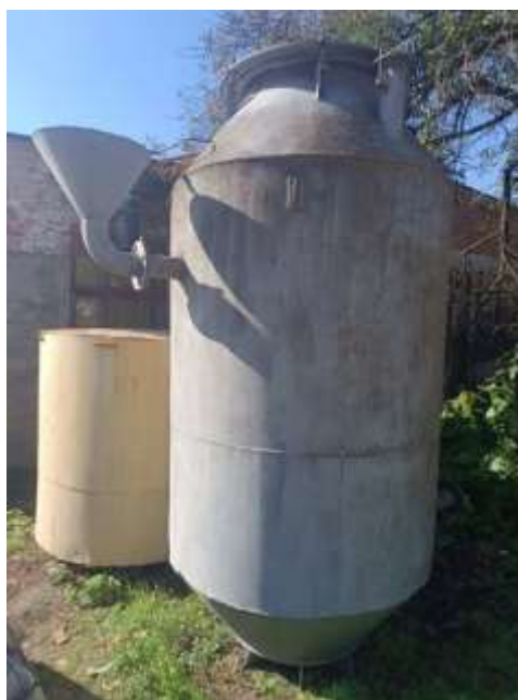
Рисунок 1 – Біогазова установка для вивчення механізмів та принципів їх роботи та процесів анаеробного зброжування та отримання біогазу
