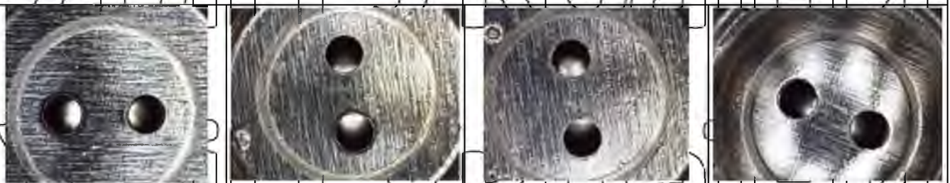
Фото соплових отворів нових форсунок із пробігом 40 тис. км. Після них очищення в УЗВ протягом 15 хвилин
