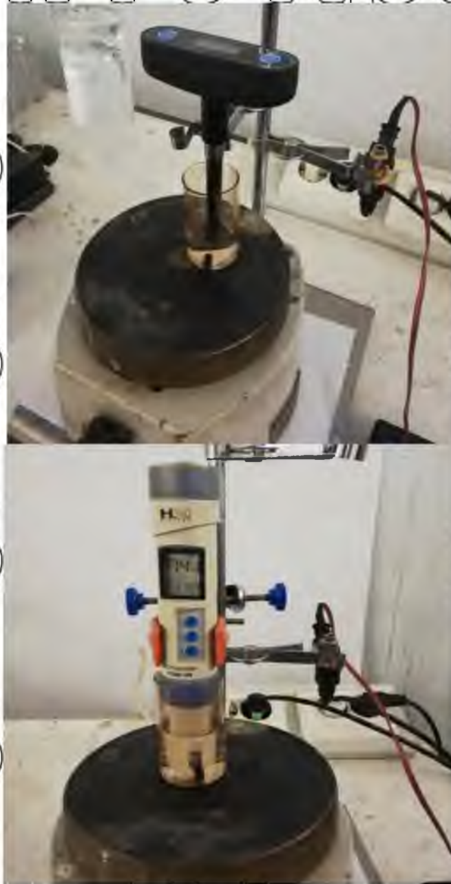
Рис. 3.3 Вимірювання водневого показника рН (а) та електропровідності \sigma рідкої фази (б)
