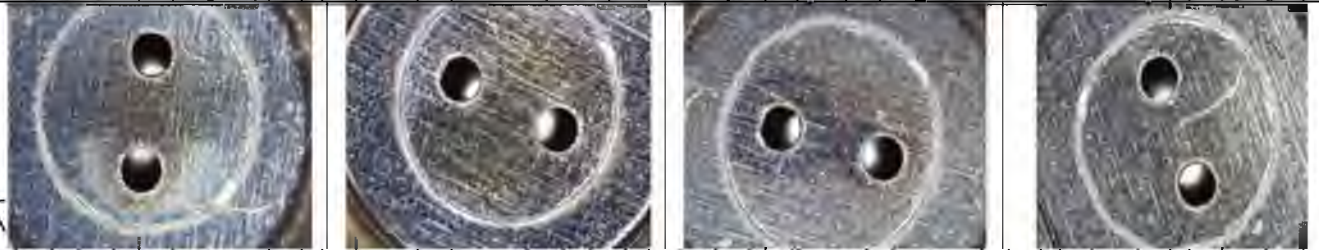
Фото соплових отворів форсунок із пробігом 40 тис. км. до очищення в УЗВ
