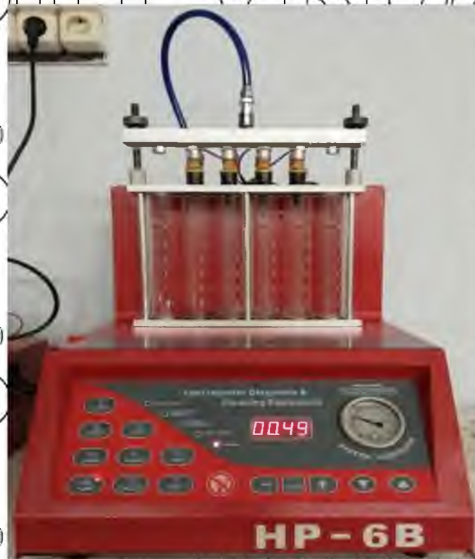
Рис. 3.4. Установка АЕ&Т «HP-6B» для оцінки технічного стану паливних форсунок
