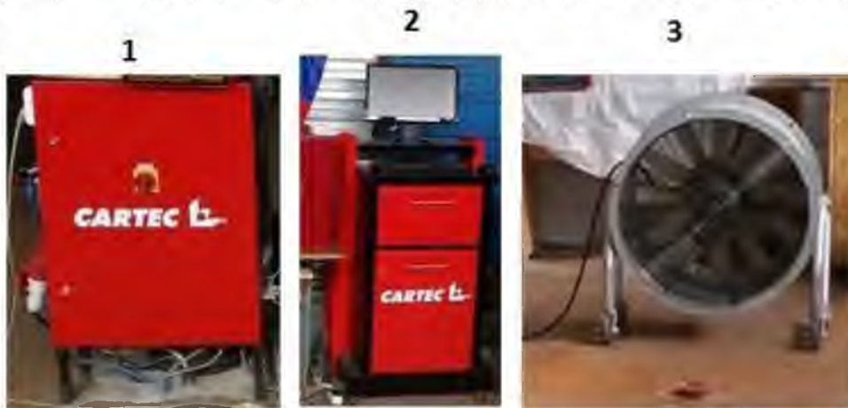
Рис. 3.12 1 – силова шафа; 2 – стійка керування з комплектом ПК; 3 – підлоговий вентилятор.
