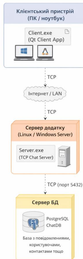
Рис. 3.3 Архітектура клієнт-серверного месенджера
