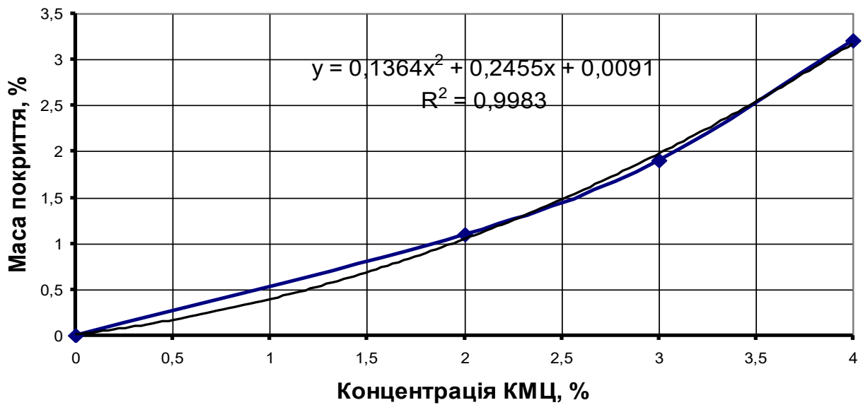
Рис. 3.14. Залежність маси покриття від концентрації КМЦ при зрошенні продукту розчином.
