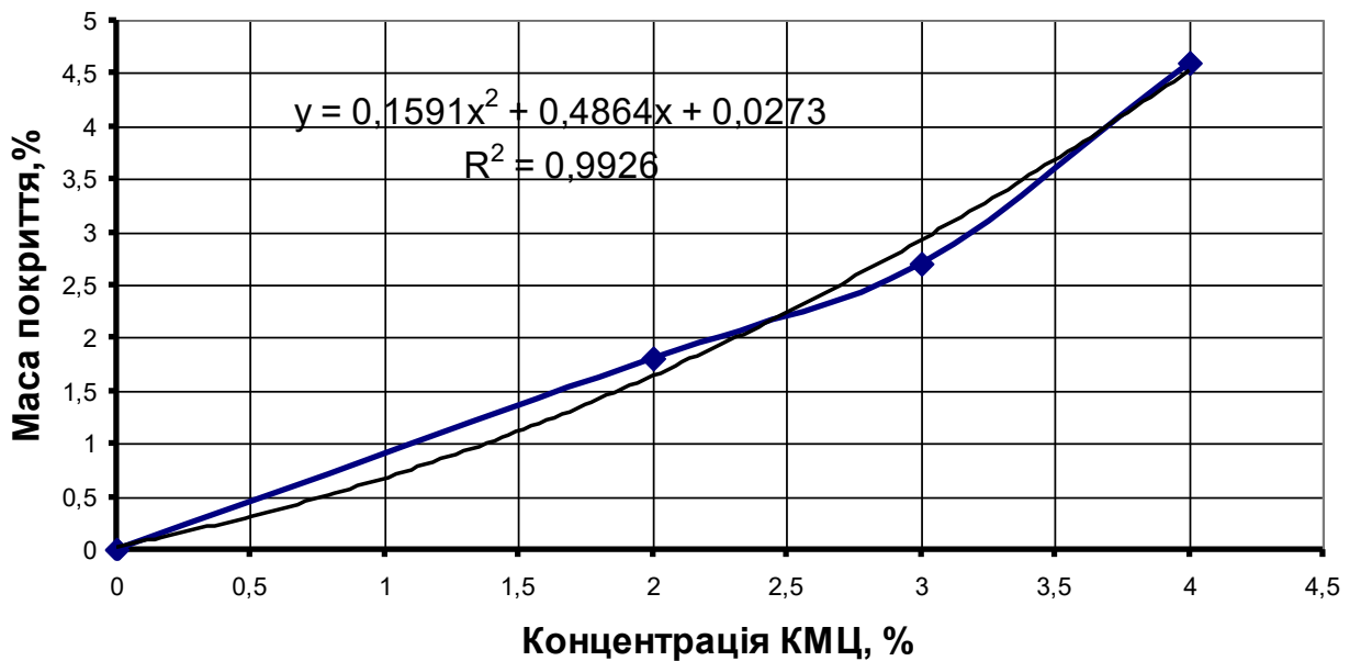
Рис. 3.15. Залежність маси покриття від концентрації КМЦ при зануренні продукту в розчин.
