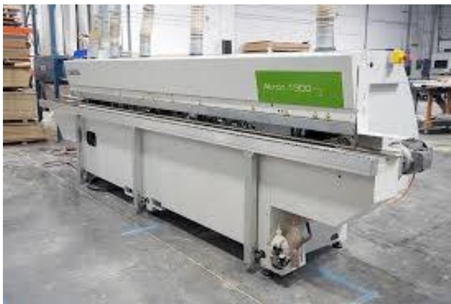
Рис. 2.5. Автоматичний крайкувальний верстат Biesse Akron 1300
