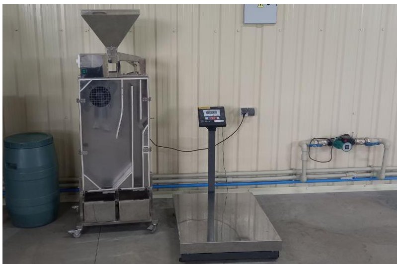
Рис. 4.4. Гравітаційний повітряний сепаратор ГПС-01 для очищення та сортування насіння хвойних порід
