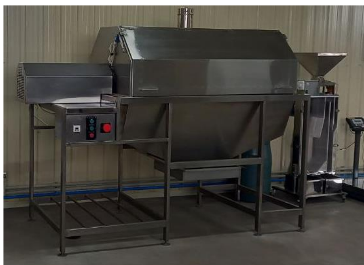
Рис. 4.3. Барабан обробки шишок БОШ-01 для вилущування насіння
