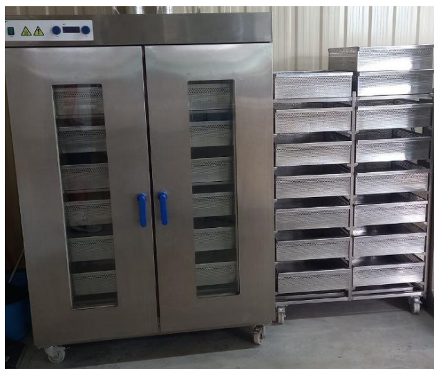
Рис. 4.1. Сушильна шафа з контролем вологості СПп-1200 для підготовки шишок до вилущування
