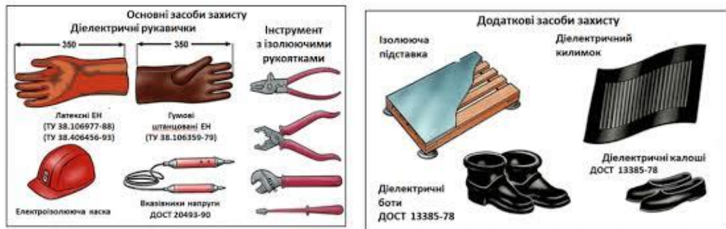
Рис 5.3 – Електрозахисні засоби при експлуатації електроустановок
