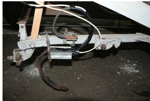
Рис. 3. Загальний вигляд стійки на лабораторній експериментальній установці: а) зі стрільчатою лапою; б) із двосторонньою оборотною плоскою лапою.
