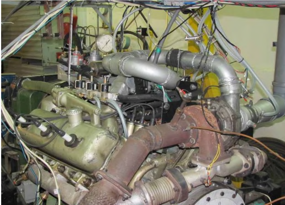
Рис. 1. Зовнішній вигляд газового двигуна 6ГЧН 13/14 з елементами системи управління розподільної подачі газу.
