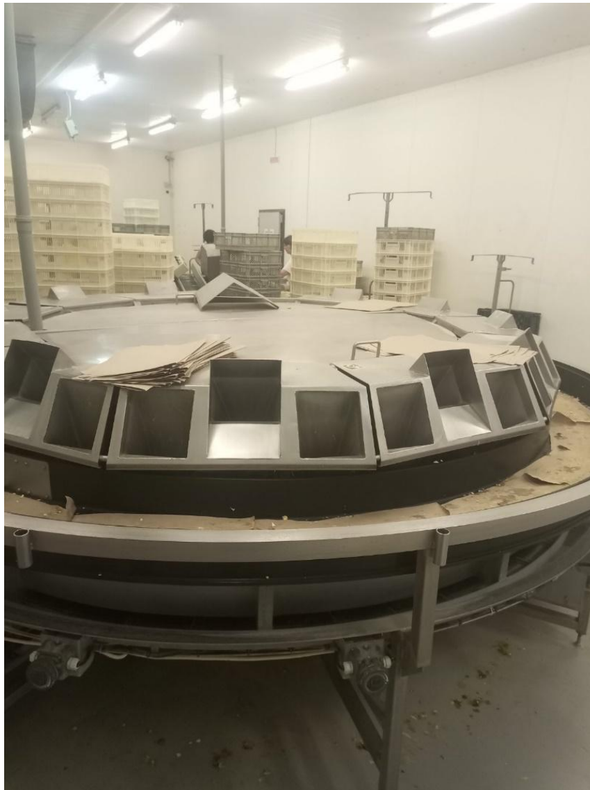
Рис. 2.7. Дисконидний транспортер для розподілу курчат за статтю (фото автора)
